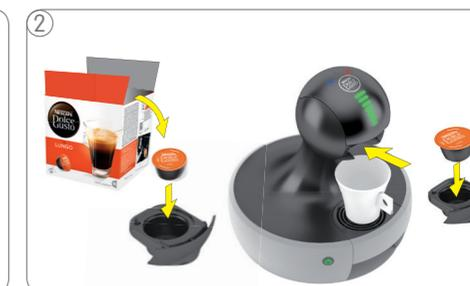
Insira a cápsula nova no suporte para cápsula e recoloque-o na máquina.
