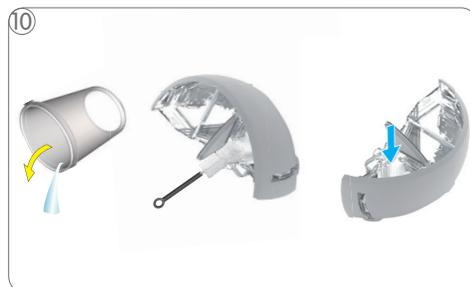
10 Esvazie e limpe o recipiente. Lave e limpe o reservatório de água. Utilize uma escova limpa e detergente se necessário. Em seguida, encha-o com água potável fresca e coloque-o na máquina.
