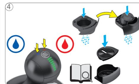
4 Enxague a máquina. Para isso, siga as instruções contidas em "5. PRIMERA UTILIZAÇÃO" na página 8. Limpe com detergente líquido e água potável e fresca ambos os lados do suporte para cápsula. Enxague o suporte de gotejamento com água potável fresca e limpe-o com uma escova limpa.
