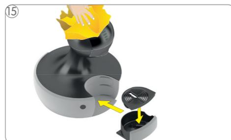
15 Limpe a máquina com um pano macio úmido. Em seguida seque com um pano seco. Coloque o suporte para xícaras no suporte de gotejamento. Então coloque o suporte de gotejamento na posição desejada na máquina.
