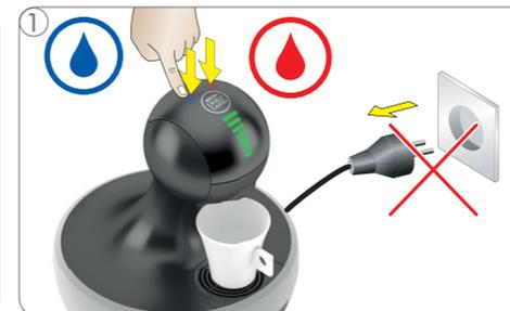
2 Sempre mantenha a máquina em pé! Para interromper o preparo, toque no ícone quente/frio novamente. Não tire o cabo de força da tomada! A máquina libera pressão.
